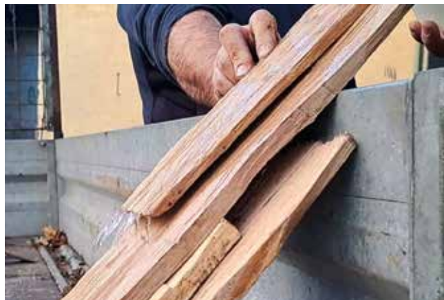
Beregnungstest für die Eichenschindeln.
