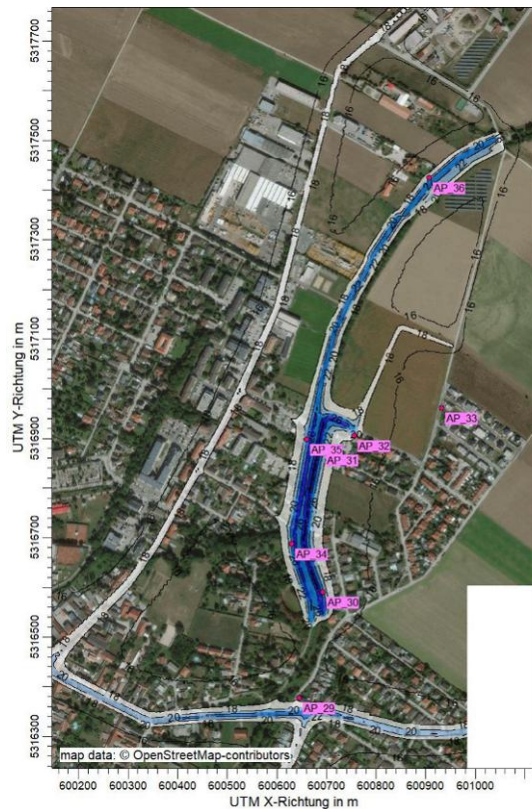
Bauphase LTR: prognostizierte Gesamtbelastung für den PM10-JMW, Annahme für die Grundbelastung: 15 \mu\text{g}/\text{m}^3 , IG-L Grenzwert: 40 \mu\text{g}/\text{m}^3
