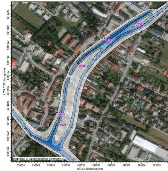
Bauphase LOW: prognostizierte Gesamtbelastung für den PM10-JMW, Annahme für die Grundbelastung: 15 \mu\text{g}/\text{m}^3 , IG-L Grenzwert: 40 \mu\text{g}/\text{m}^3
